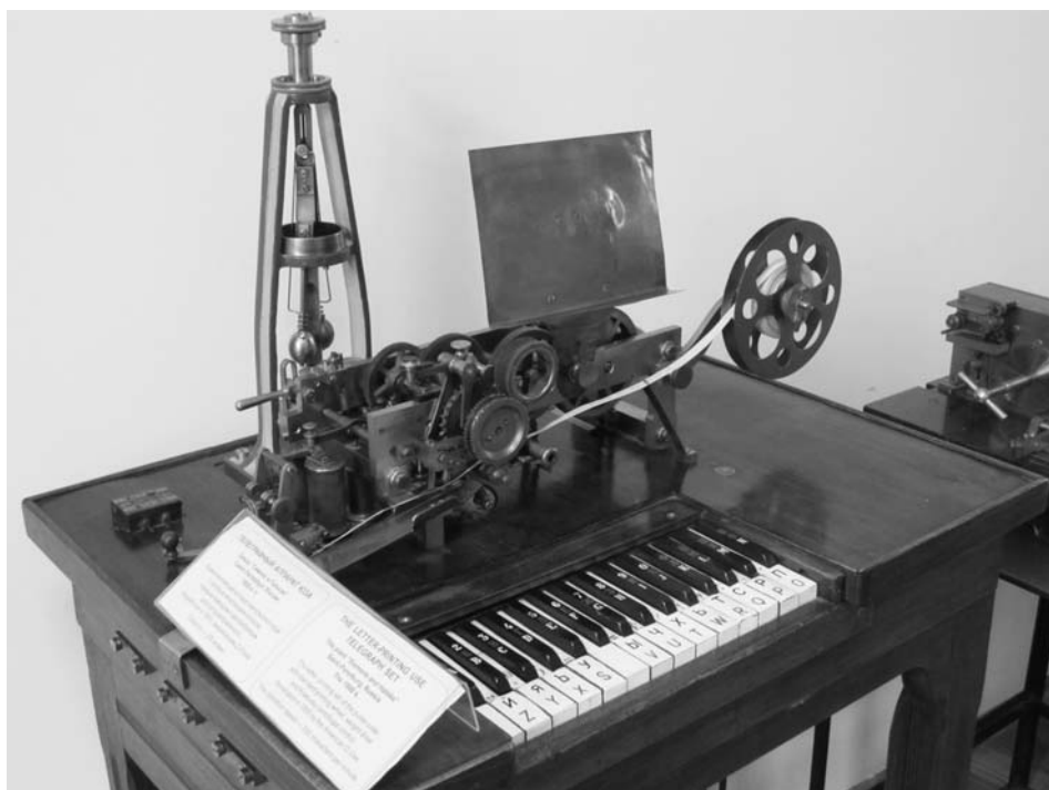
Il. 9. Aparat telegraficzny Hughesa z obrotowym regulatorem obrotów, źródło http://davidewardhughes.com/wp-content/gallery/ht4/3-Russian-Printing_Telegraph.jpg [dostęp 3.04.2021].
