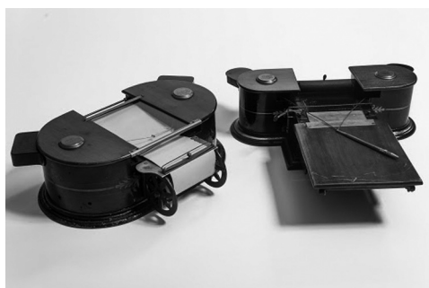
Il. 8. Nadajnik (po lewej) i odbiornik telautografu. Źródło: Muzeum Poczty i Telekomunikacji w Berlinie
