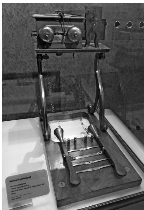
Fot. 1. Aparat telegraficzny z 1846 r. pochodzący z warsztatu Eklinga. Ekspонат z Muzeum Techniki w Wiedniu. Źródło: Wikipedia
