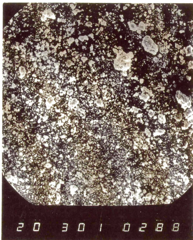
Rysunek 8. Obraz SEM próbki Zn/2NaCl otrzymanej metodą B (wzmocnienie \times 300 ).
