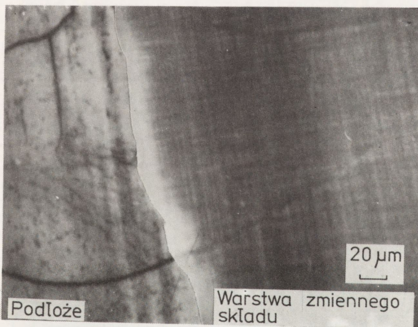
Rys. 2. Katodoluminescencyjne obrazy próbki B a) szlif skośny w stosunku do powierzchni próbki (7 mm = 20 μm), (10 mm = 100 μm); b) płaszczyna przełomu z widocznymi obszarami podłoża, warstwy epitaksjalnej oraz powierzchni warstwy epitaksjalnej (6,5 mm = 20 μm); c) powierzchnia warstwy (6,5 mm = 20 μm)
