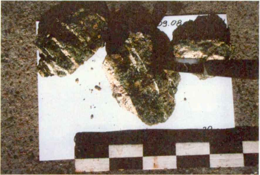
Ryc. 5. Wydobyta z głębokości 300 cm na spłaszczeniu podszczytowym Ślęży (650 m n.p.m.) chemiczna zwietrzelina gabra. Widoczne żyłki jasnych minerałów świadczą o tym, że zwietrzelina powstała in situ . Każdy z jednobarwnych segmentów przymiaru ma długość 5 cm.
