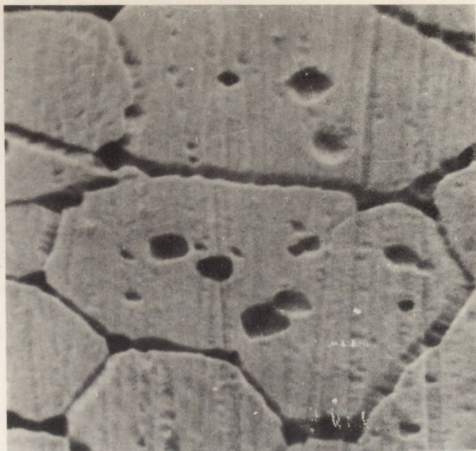
Rys. 1. Zdjęcie z mikroskopu skaningowego JSM – S1, pow. 3000x. Fragment powierzchni spieku ferrytu niklawo-cynkowego \text{Ni}_{0,36}\text{Zn}_{0,64}\text{Fe}_2\text{O}_4 ; próbka wycięta z wnętrza spieku, wypolerowana mechanicznie i wytrawiona w 50-procentowym wodnym roztworze kwasu solnego
