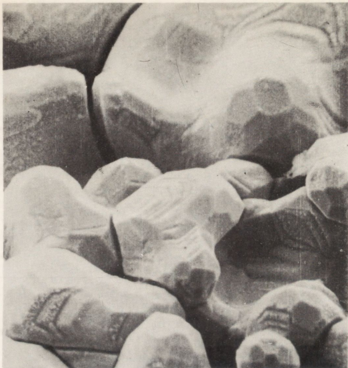
Rys. 5. Zdjęcie z mikroskopu skaningowego JSM – S1, pow. 3000×. Fragment powierzchni spieku ferrytu niklawo-cynkowego \text{Ni}_{0,36}\text{Zn}_{0,64}\text{Fe}_2\text{O}_4 spiekanego przez 40 godzin w temperaturze 1573 K i ochłodzonego gwałtownie do temperatury 273 K w oleju silikonowym
