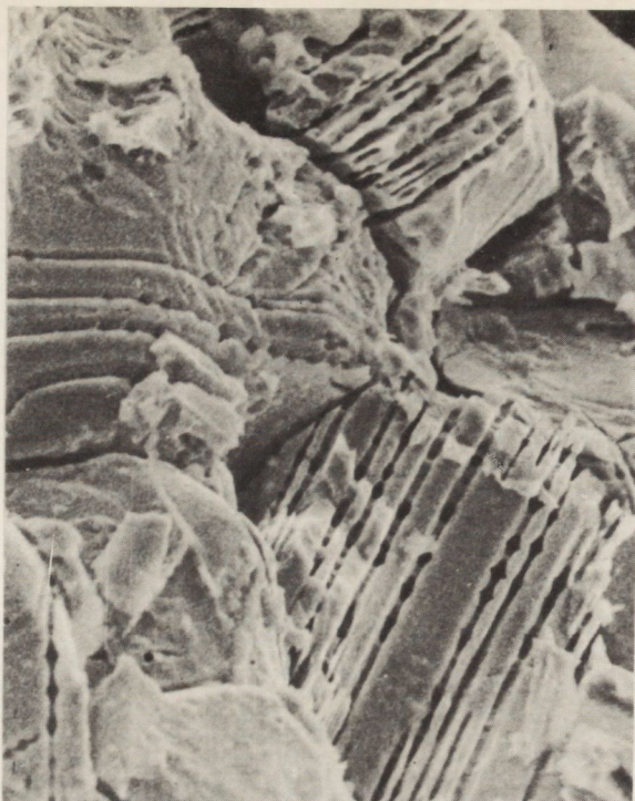
Rys. 8. Zdjęcie z mikroskopu skaningowego JSM – S1, pow. 3000 \times . Fragment przełomu spieku ferrytu nikłowo-cynkowego \text{Ni}_{0,36}\text{Zn}_{0,64}\text{Fe}_2\text{O}_4 spiekane go przez 30 godzin w temperaturze 1573 K, ochłodzonego do temperatury otoczenia wraz z piecem i trawionego 50-procentowym wodnym roztworem kwasu solnego w temperaturze 323 K
