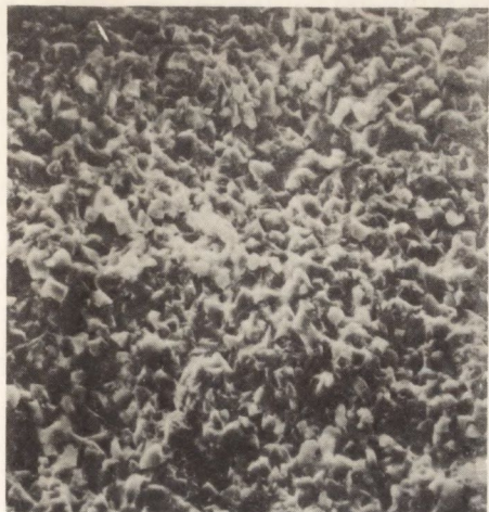
Rys. 4. Zdjęcie z mikroskopu skaningowego; obraz elektronów wtórnych (pow. 1000×) a – materiał wyjściowy, b– spiek diamentowy
