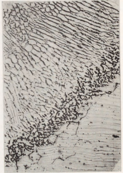
Rys. 6. Mikrostruktury linii wtopienia złączy spawanych ze stali B a/ 0% N 2 , 3,7% ferrytu \delta wg pomiarów magnetycznych, b/ 9% N 2 , 0% ferrytu \delta wg pomiarów magnetycznych. Trawienie elektrolityczne w 10n NaOH. Powiększenie 200 \times .
