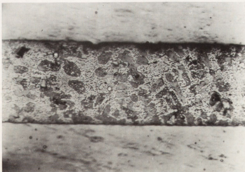
Rys. 6. Złącze stal-stal lutowane pastą lutowniczą LC40-wa1. Powiększenie 200×. Trawiona warstwa PbSn
