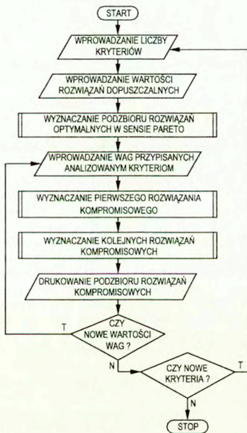
Rys. 4.36. Ogólny schemat blokowy Metody Wyznaczania Rozwiązań Kompromisowych w skończonym zbiorze rozwiązań dopuszczalnych
