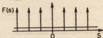
Rys. 3. Efekt dyfrakcyjny sinusoidalnego zaburzenia sieci
