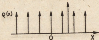
Rys. 4. Atom międzywęzłowy powoduje pojawienie się \lambda i zmienione wysokości pików
