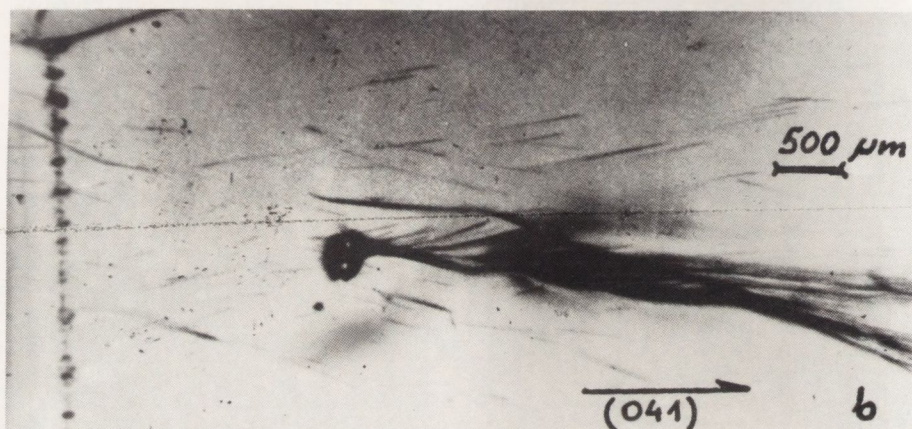
Rys. 2. a - optyczny obraz wtrącenia z "ogonem", zaznaczony odcinek pokazuje kierunek krystalizacji sektora Z zawierającego defekt, b - odbiciowy topogram rentgenowski pokazanego wtrącenia, obszar ogona jest wypełniony dyslokacjami, liniowy kontur z lewej strony zdjęcia odpowiada granicy między zarodźką a sektorem Z.
