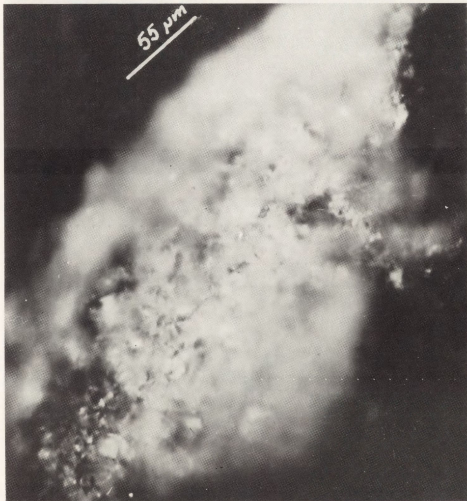
Rys. 1. Optyczne obrazy wtrąceń uzyskane w świetle rozproszonym: a - obiekt monolityczny typu A, b - agregat krystaliczny typu B, c - zwarty poli- kryształ typu C.
