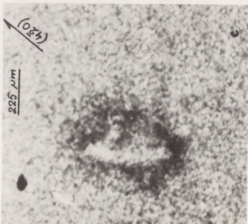
Rys. 4. Optyczne i rentgenowskie obrazy odbiciowe skupiska zawierającego obiekt typu A, B i C. Kierunek wzrostu monokryształu prostopadły do płaszczyzny zdjęć. Topogramy 4c i 4d ujawniają różnice kształtu obszaru zdeformowanego przy powierzchni i w głębi próbki.
