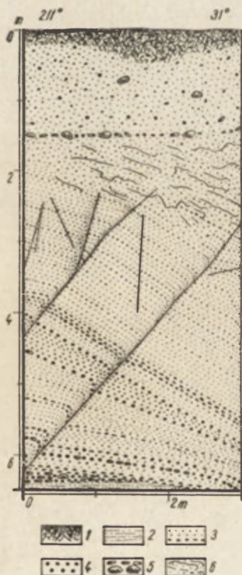
Ryc. 11. Budowa wewnętrzna kemu położonego w okolicy „Czerwonej Karczmy” na północny wschód od Wilcza. 1 — gleba, 2 — mułek piaszczysty, 3 — piaski drobne, średnie i grube, 4 — żwiry drobne i średnie, 5 — żwiry grube i głąziki, 6 — smugi żelaziste w utworach piaszczystych
