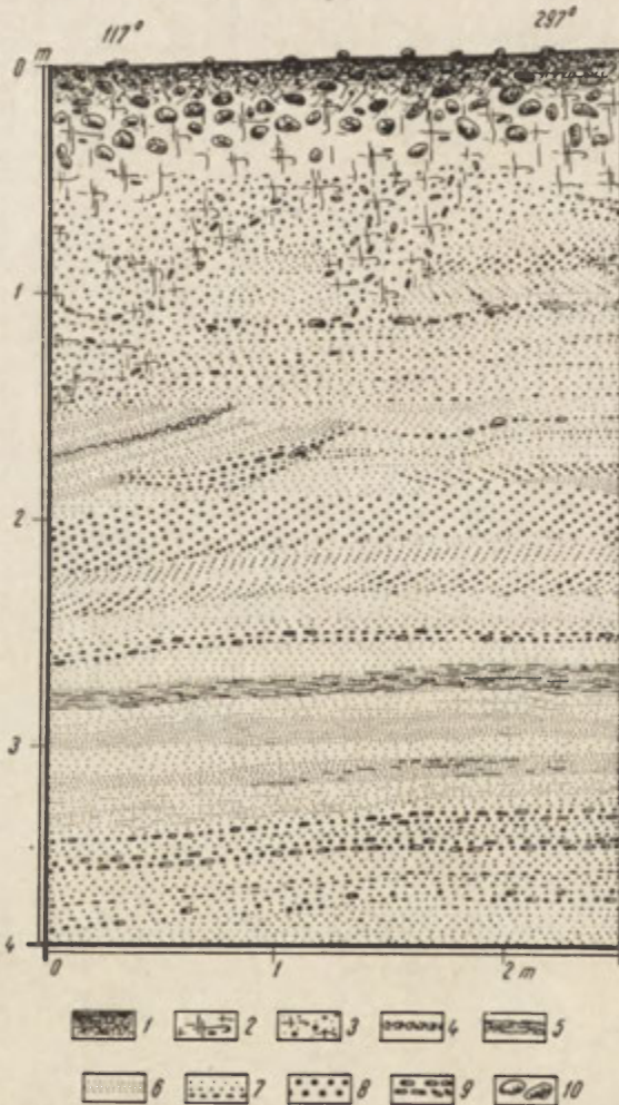
Ryc. 10. Budowa wewnętrzna kemu na wschód od Wilcza. 1 — gleba, 2 — glina brunatna silnie zbita, 3 — piasek gliniasty, 4 — il, 5 — mułek ilasty, 6 — mułek, 7 — piaski drobne, średnie i grube, 8 — żwiry drobne i średnie, 9 — żwiry grube, 10 — gładziki
