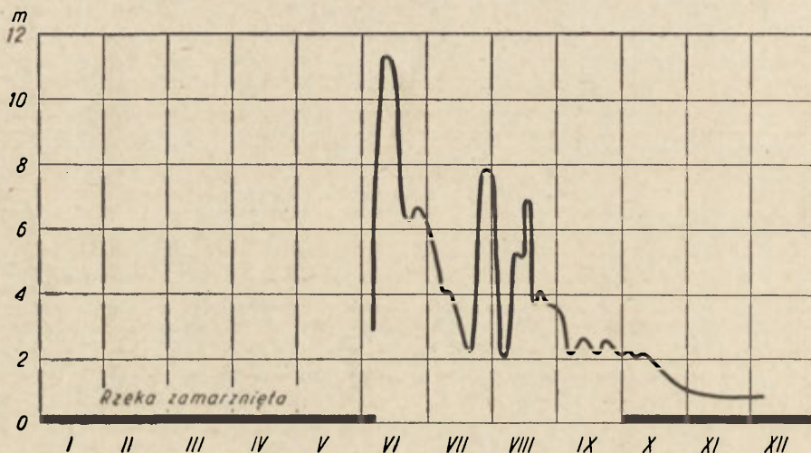
Ryc. 7. Roczny wykres pomiarów przepływu na rzece Anabar koło miejscowości Saskylach w r. 1944 (według Dawidowa, 3)
