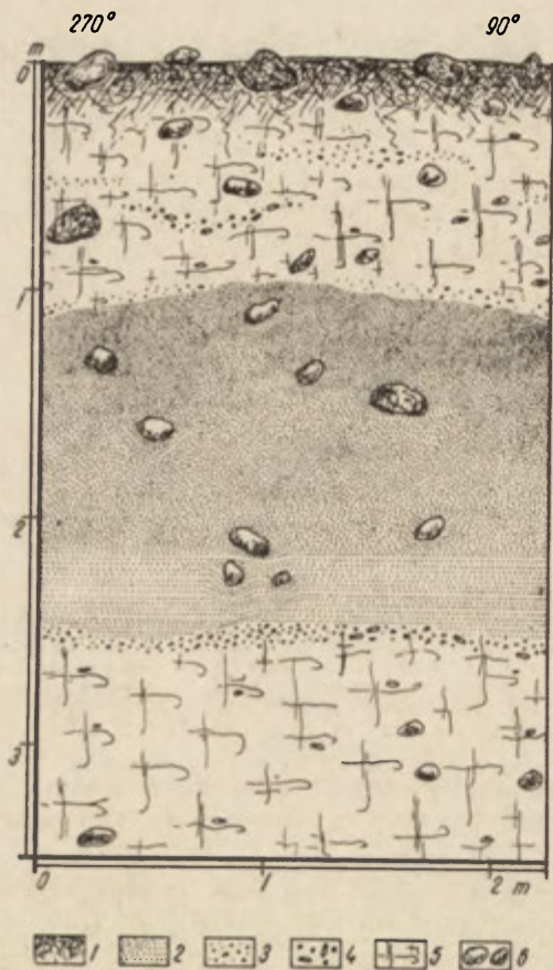
Ryc. 1. Budowa wewnętrzna moreny czołowej na zachód od Linowca. 1 — gleba, 2 — mułki, 3 — piaski różnoziarniste, 4 — żwiry różnoziarniste, 5 — glina morenowa, 6 — głaziki Interior structure of end moraine, W of Linowiec 1 — soil, 2 — silts, 3 — unequigranular sands, 4 — unequigranular gravels, 5 — boulder clay, 6 — pebbles
