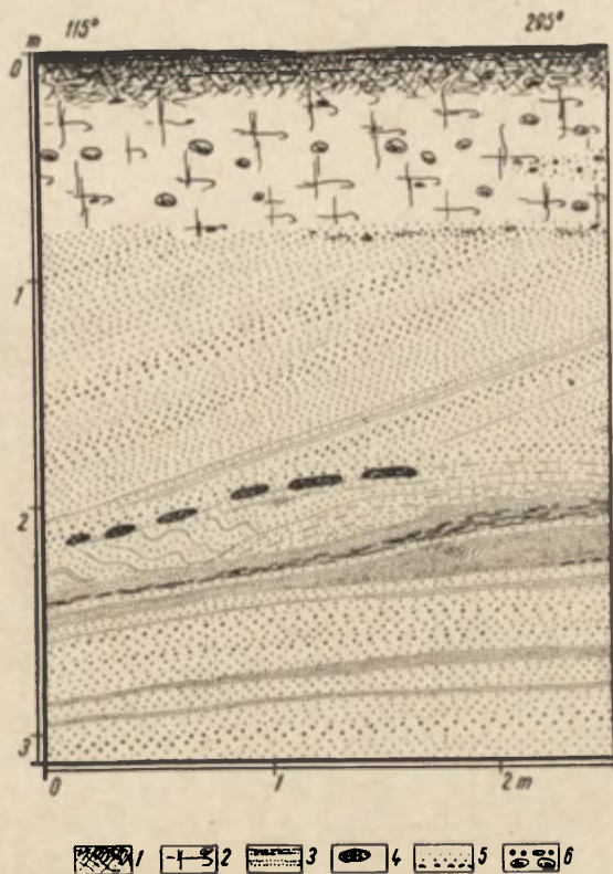
Ryc. 12. Budowa wewnętrzna kemu położonego nad rynną jeziora Borówno. 1 — gleba, 2 — glina brunatna, 3 — mułek ilasty i mułek, 4 — toczęnce iltu, 5 — piaski drobne, średnie i grube, 6 — żwiry i głaziki Interior structure of kame situated above Borówno Lake channel. 1 — soil, 2 — brown loam, 3 — clayey silt, and silt, 4 — clay tongallens, 5 — fine-, medium-, and coarsegrained sands, 6 — gravels and pebbles
