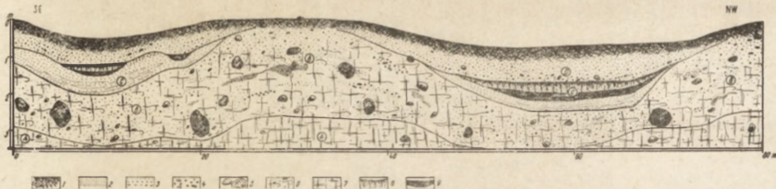
Ryc. 13. Budowa wewnętrzna równiny ablacyjnej i płytkich zagłębień wytopiskowych na zachód od wsi Niwy (czterokrotne przewyższenie). A — osady subglacjalne, B — supraglacjalne utwory ablacyjne, C — akumulacja związana z wypełnianiem zagłębień wytopiskowych, D — holocenska pokrywa deluwialna, 1 — gleba, 2 — mułki, 3 — piaski drobne, średnie i grube, 4 — żwiry o zróżnicowanej frakcji, 5 — gązłki i gązy, 6 — piaski gliniaste, 7 — glina brunatna, 8 — piaski silnie shumusowane, 9 — torfy
