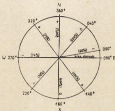
Ryc. 1. Rozkład dodatnich i ujemnych odchyłek kierunku wiatru na Kasprowym Wierchu od kierunku w swobodnej atmosferze dla wiatrów o prędkości większej od 5 m/sec
