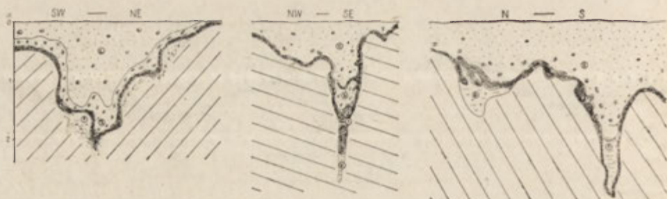
Ryc. 3. Formy krasowe w kamieniołomie w Smerdyni; 1 — piaski jasne, w spągu zglinione, z otoczkami skał północnych; na żwirach widoczna obróbka eoliczna; 2 — brunatna glina, silnie spiaszczona; 3 — zwietrzelina czerwono-brunatna ( terra rossa ); 4 — biały osad wapienny, układający się w smugi nacieków; 5 — piaski drobne, jasne; 6 — biały, pylasty osad wapienny; 7 — zwietrzelina skalna podłoża z dużą domieszką wapiennego osadu pylastego.
