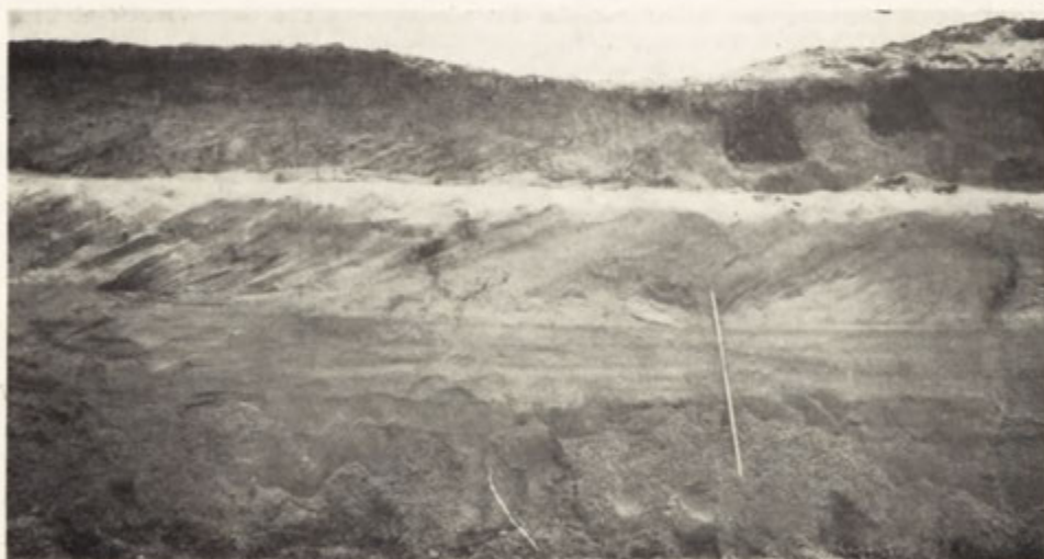
Fot. 4. Pustelnik II. Ściana południowa zachodniego rozwidlenia wielkiego wykopu. W pobliżu miejsca, które przedstawia to zdjęcie, wykonany został w 1953 r. szurf (ryc. 2). W dolnej połowie zdjęcia piaski drobnoziarniste i mułkowate, poziomo warstwowane — piaski warstwy 3 w szurfie 2. Nadległa seria piasków przekątnie warstwowanych, z partią piasków zaburzonych — aluwia pra-Wisły górnej pokrywającej tarasu, w szurfie oznaczone cyfrą 4
