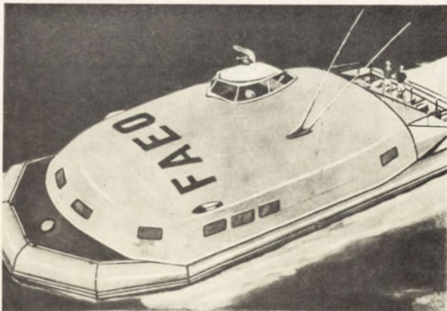
Fot. 2. Łódź podwodna „Amphitrite”. Długość 20 m, szerokość 9 m, szybkość do 25 węzłów. Przeznaczona do badań geologicznych i grawimetrycznych
