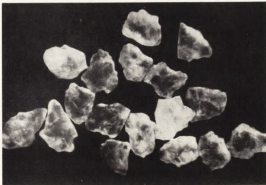
Fot. 1. Pierwsza klasa obtoczenia (fot. R. Więckowski) Photo. 1. First class of roundness (by R. Więckowski)
