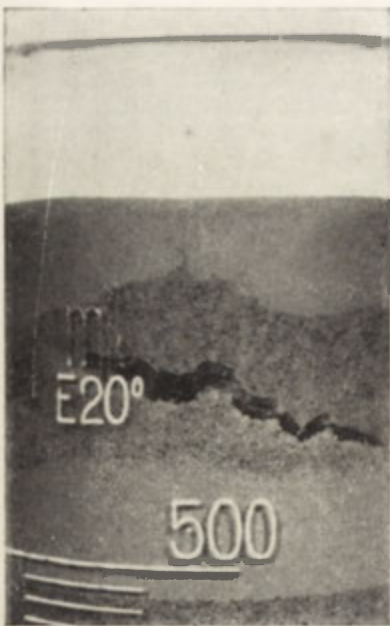
Fot. 6. Stadium pierwsze rozwoju komory gazowej w warstwie piasku
