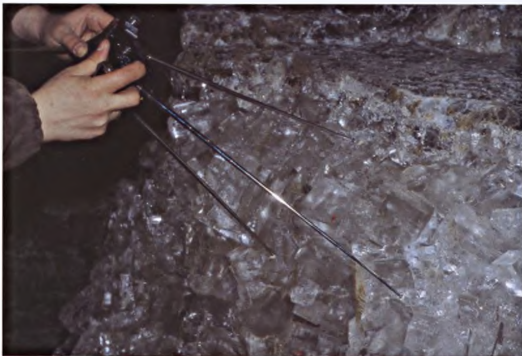
Ryc. 9.17. Specjalnie zaprojektowany statyw umocowany do obiektywu aparatu fotograficznego służący do wykonywania szczegółowych zdjęć dokumentacyjnych. Trzy nogi statywu teleskopowo wysuwane na odpowiednią odległość i ustawiane w oznaczonych punktach pozwalają na uzyskanie powtarzalnych ujęć fotograficznych dokumentowanego obiektu.
