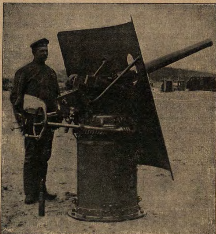
Marine-Schnellenergeschütz mit Schutzschild.
