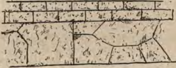
Murs en deux appareils différents (pisé) à Mansiche.
