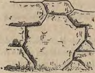
Spécimen du grand appareil polygonal ( hatun Rumiocce du Cuzco).
