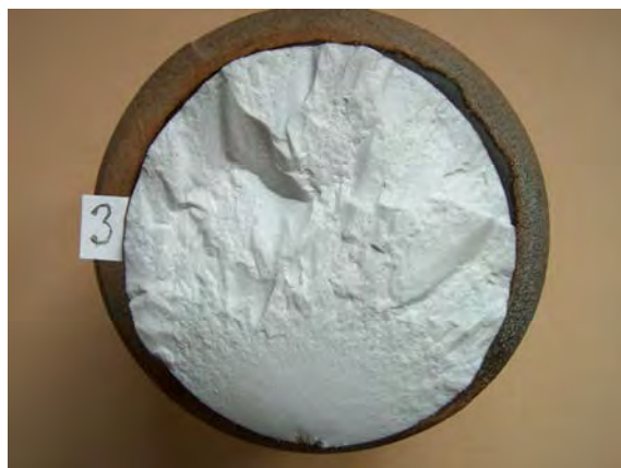
Rys. 8.14. Obraz przełamu izolatora LS 75/21 z 1971 roku, oznaczonego 3. Widoczne jest duże wtrącenie na granicy pnia i towarzyszący mu rozległy obszar kruchych pęknięć – tzw. „lustro”.
