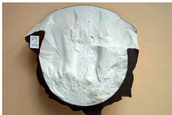
Rys. 8.3. Przełam pnia izolatora LS 75/21 z 1970 roku, oznaczonego 2. W dolnej części widoczne jest drobne wtrącenie na granicy porcelany i szkliva oraz towarzyszący mu niewielki obszar kruchych pęknięć – tzw. „lustro”.
