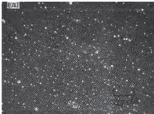
Rys. 17. Włóknista struktura obserwowana w eutektyce \text{HfO}_2 -W, ciemne obszary - \text{HfO}_2 , jasne obszary - W [35]. Fig. 17. Fibrous structure observed in eutectic \text{HfO}_2 -W, dark regions - \text{HfO}_2 , bright regions - W [35].
