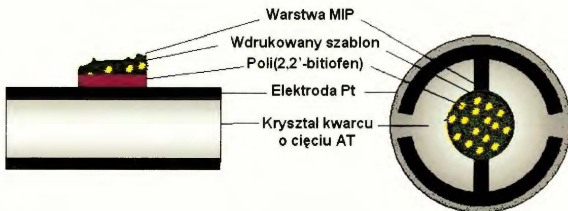
Schemat 18. Chemiczny czujnik piezomikrograwimetryczny – rezonator kwarcowy pokryty warstwą MIP osadzoną elektrochemicznie na PBT warstwie zaporowej.
