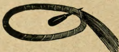
Ryc. 62. Pierwszy krąg z tkwiącym w nim szydłem.
