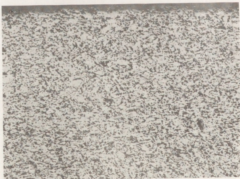
Rys. 9. Nietrawiony szlif spieku GF + 10% wag. ZnO, czas mieszania 1 h – na mokro, pow. 80×
