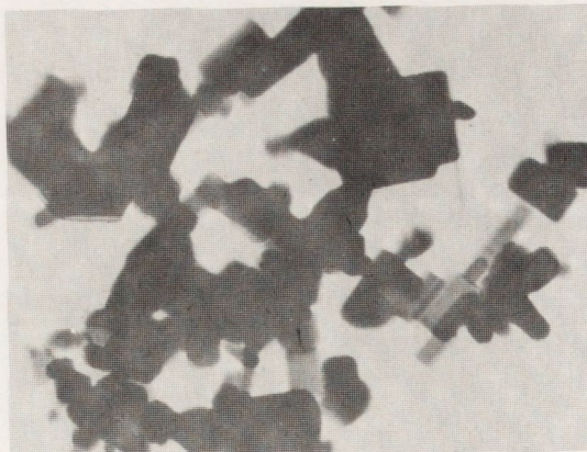
Rys. 3. Proszek ZnO, pow. 19000×
