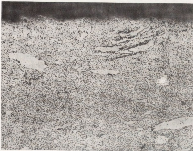
Rys. 6. Nietrawiony szlif spieku GA + 10% wag. ZnO, czas mieszania 2 h – na sucho, pow. 80×
