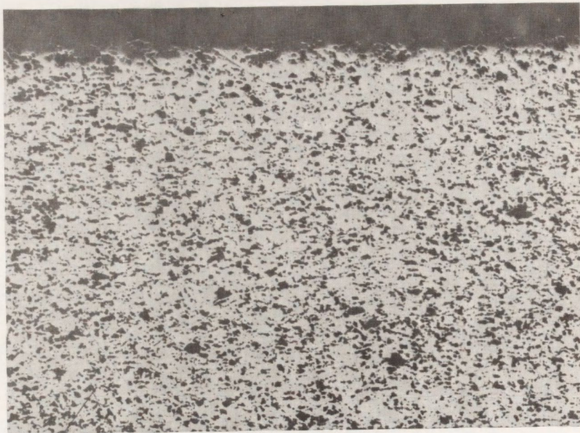
Rys. 8. Nietrawiony szlif spieku GF + 10% wag. ZnO, czas mieszania 1/2 h – na mokro, pow. 80×
