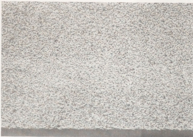
Rys. 11. Nietrawiony szlif spieku GA + 10% wag. ZnO, czas mieszania 10 h – na mokro, pow. 80×
