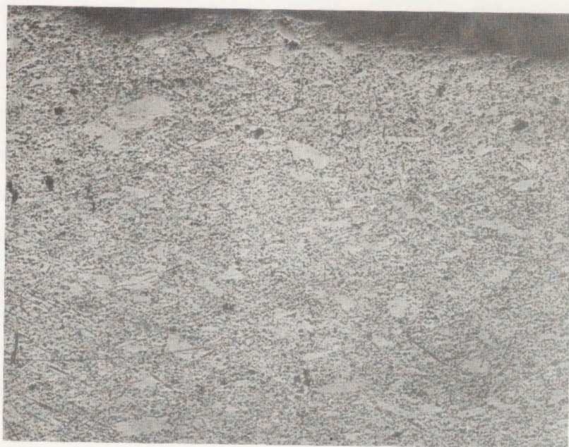
Rys. 7. Nietrawiony szlif spieku GA + 10% wag. ZnO, czas mieszania 2 h – na mokro, pow. 80×
