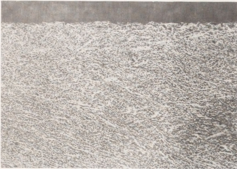
Rys. 10. Nietrawiony szlif spieku GF - 10% wag. ZnO, czas mieszania 10 h – na mokro, pow. 80×
