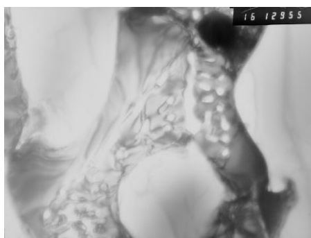
Rys.4.30. Struktura materiału na głębokości około 50 \mu m od powierzchni badana na cienkich foliach z przekroju wzdłużnego próbki –. Próbka stopowana laserowo, TEM.
