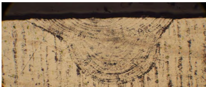
Rys.3.32. Kształt strefy przetopienia stali 304, prędkość posuwu 150 mm/min.
