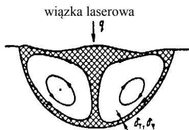
Rys.1.21. Schemat przepływu cieczy przy dużych liczbach Reynoldsa [52].
