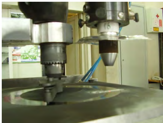
Rys.4.4. Zdjęcie głowicy do nagniatania ślizgowego, głowicy laserowej i stołu z zamontowaną próbką.
