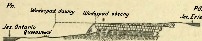
Ryc. 162. Przekrój przez wodospad Niagara: 1. piaskowce, 2. miękkie łupki, 3. twarde wapienie, 4. osady rzek.
