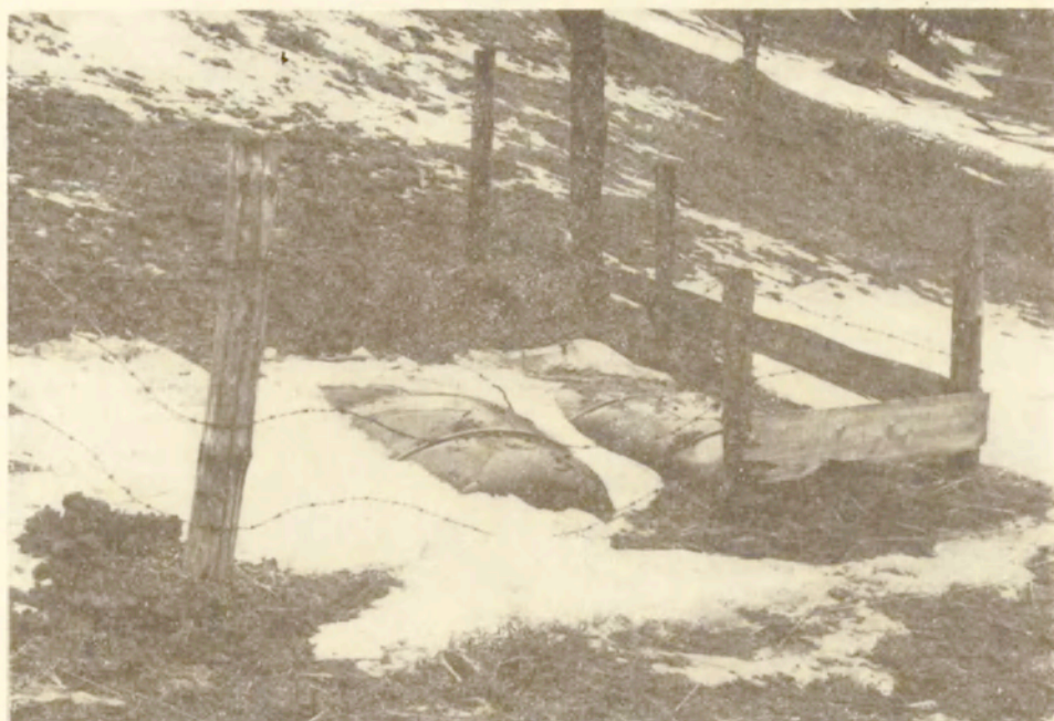
Fot. 7. Worki z folii do pomiarów splywu rozproszonego, zainstalowane u podnóża stoku doświadczalnego w zlewni Homerki
