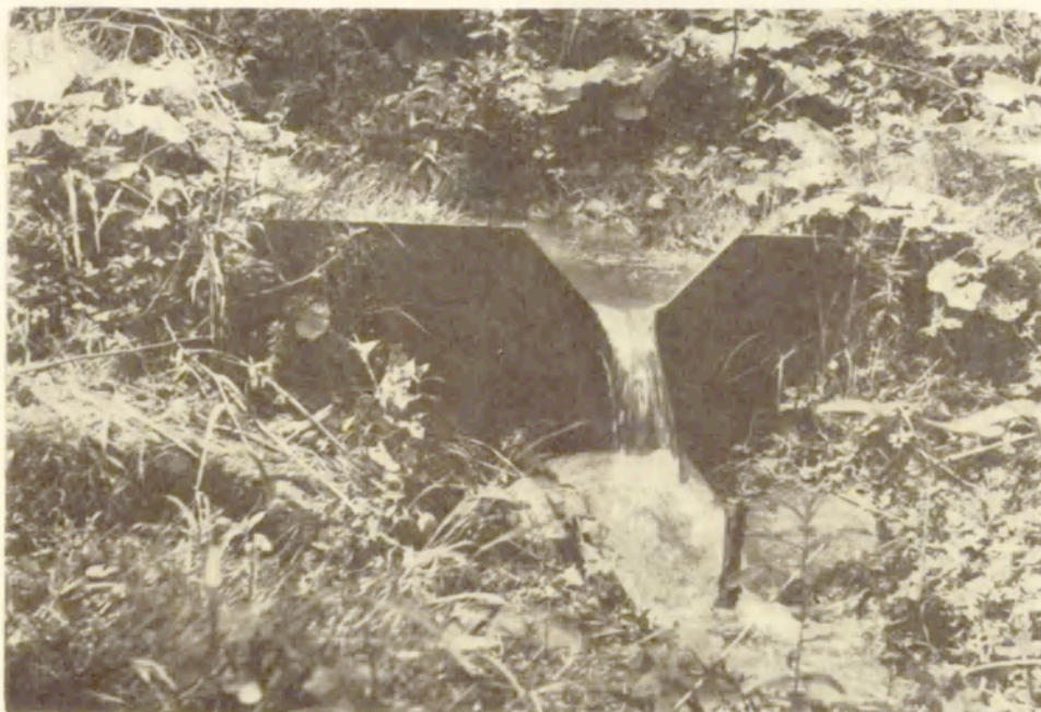
Fot. 6. Przelew z trójkątnym wycięciem zainstalowany w rozcięciu erozyjnym na stoku doświadczalnym w zlewni Homerki
