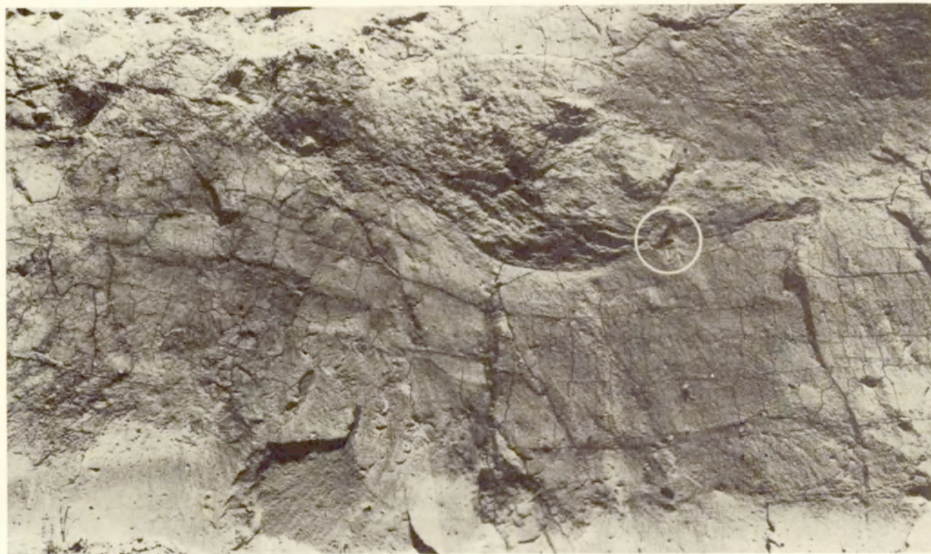
Fot. 5. Nieco zwietrzała ściana dolnej gliny morenowej, ujawniająca lokalną strukturę kohezyjnego splywu materiału morenowego oraz system spękań poziomych i pionowych. Wielkość szczyryka (w okręgu) – 12 cm A little weathered wall of the lower till, displaying local cohesive flow structure of till and a system of horizontal and vertical joints. Length of the pocket-knife (in the circle) – 12 cm
