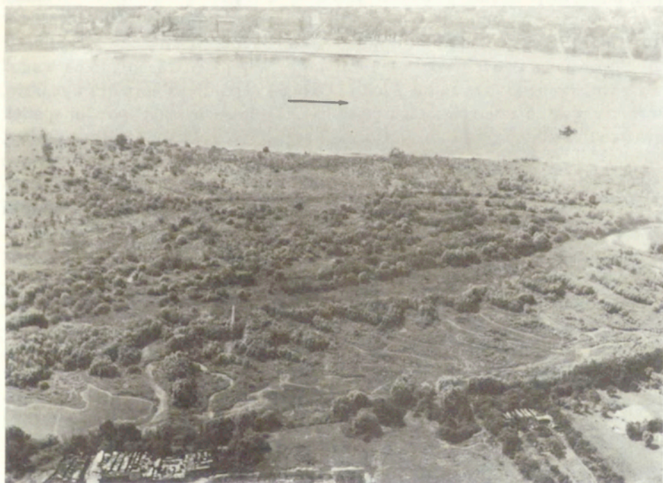
Fot. 8. Nowo powstały poziomy zalewowy powyżej mostu drogowego we Włocławku (prawy brzeg), będący efektem procesów erozyjnych poniżej stopnia wodnego we Włocławku Fot. lipiec 1988 r.
