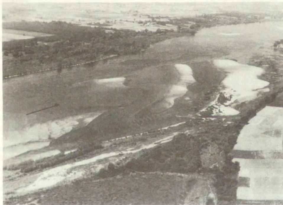
Fot. 15. Łachy podłużne roztokowego odcinka rzeki usytuowane w sąsiedztwie czoła strefy erozyjnej, około 20 km poniżej stopnia wodnego Włocławek. Kierunek płynięcia wody oznaczono strzałką. Fot. lipiec 1988 r.
