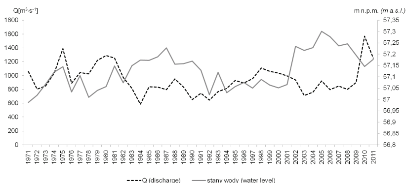
Ryc. 4.11. Przebieg średnich rocznych stanów wody na stopniu wodnym „Włocławek” na tle zmienności średniego rocznego natężenia przepływu w przekroju hydrometrycznym Kępa Polska w wieloletniu 1971-2011
