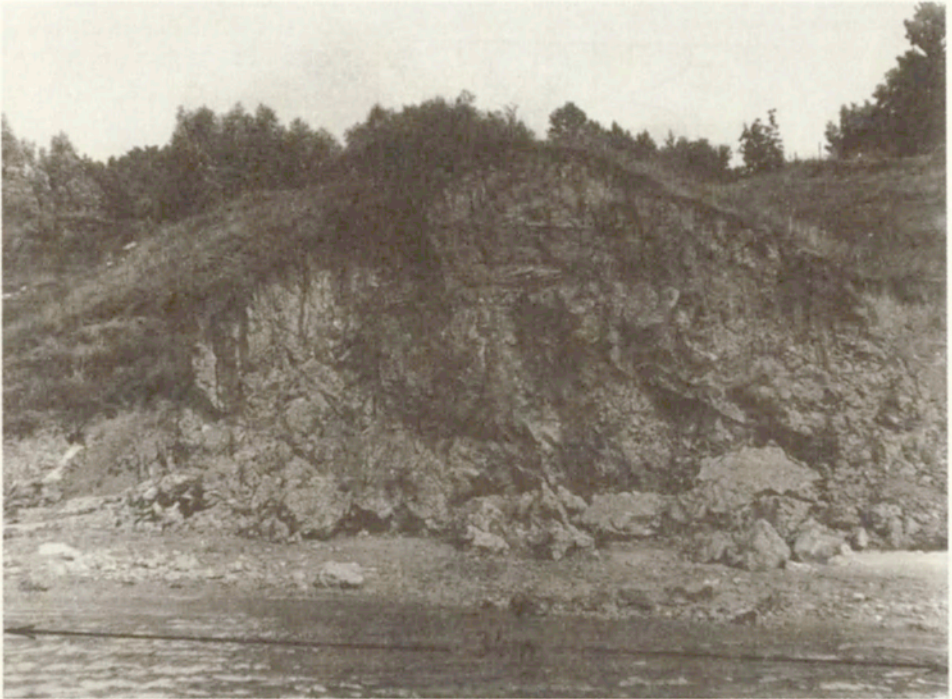
Fot. 3. Brekcyjowa tekstura iłów plioceńskich w świeżym odsłonięciu — system szczelin, spękań i zlustrowań
