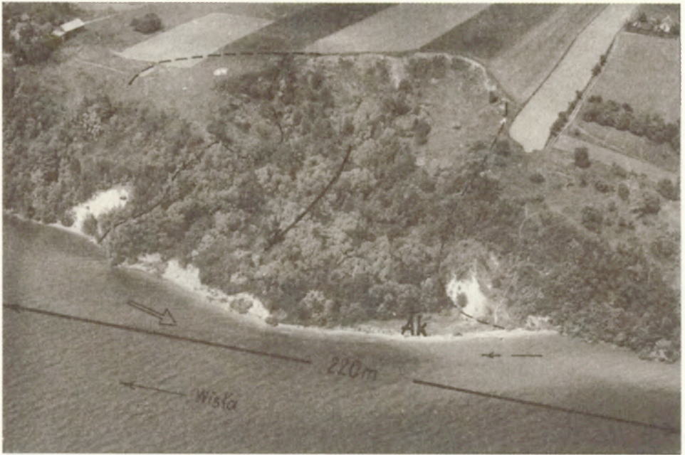
Fot. 11. Wypukłość linii brzegowej wzdłuż stale czynnego osuwiska w Kamienicy (km 659,6). Linia przerywana oznacza zarys osuwiska oraz uskoki z 1972 r. Oznaczenia strzałek — ryc. 19; Ak — forma akumulacyjna (odsyp)
