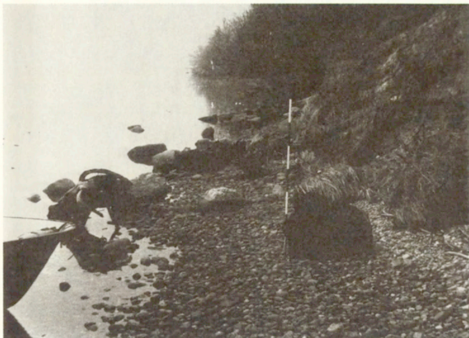
Fot. 21. Rezydium z rozmycia bruku morenowego w Murzynowie (km 647,8); brzeg przygłębiony, a abrazja mała (1,7 m)
