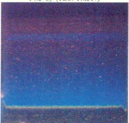
e) Eksperyment nr 48 ( T_h \cong 55.0^\circ\text{C} i T_c \cong 18.0^\circ\text{C} ) (TLC: TC1001)
