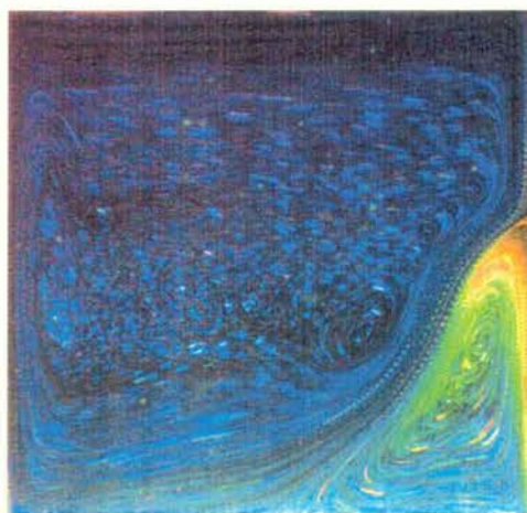
b) Eksperyment Nr 11 ( T_h = 10^\circ\text{C} , T_c = 0^\circ\text{C} ) TLC: MixC
