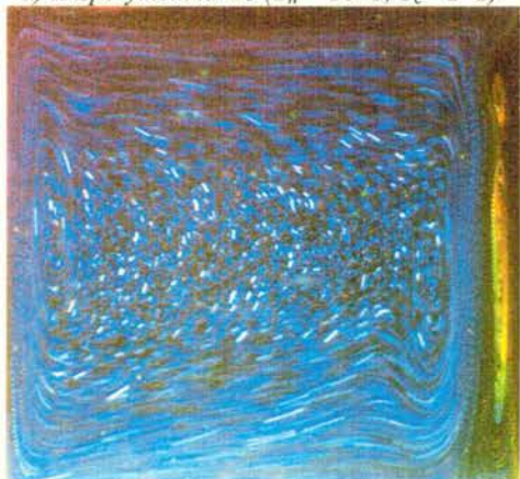
c) Eksperyment nr 1 ( T_h = 10\text{ }^\circ\text{C} , T_c = -2\text{ }^\circ\text{C} )
