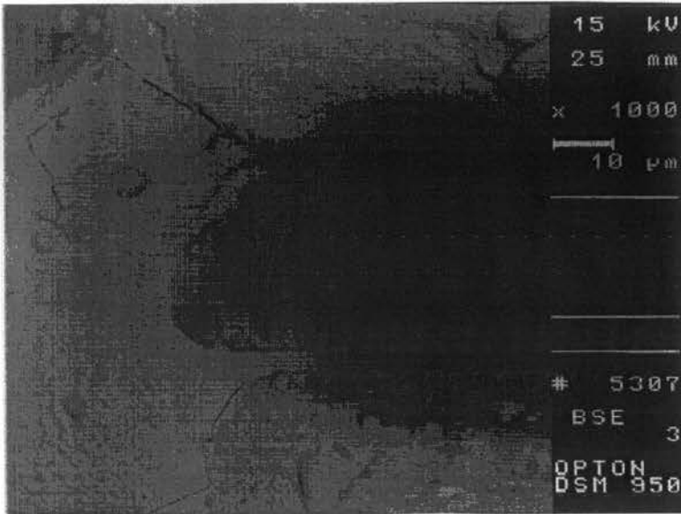
Rys. 4 Przeobrażenia chemiczne wierzchniej warstwy obrabianej laserowo (uzyskano za pomocą mikroskopu elektronowego OPTON DSM 950)
