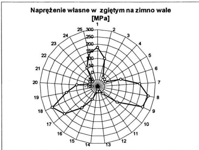
Rys.46 Obwodowy rozkład naprężeń wzdłużnych wyznaczonych metodą ultradźwiękową w prostowanym na zimno wale [69].
