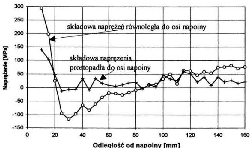
Rys. 35 Wyznaczone składowe naprężenia wprowadzonego w wyniku nałożenia napoiny.
