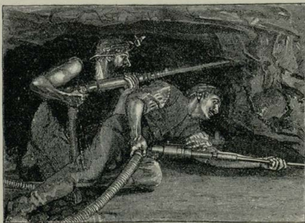
Bohrung auf hydraulischem Wege in einer Erzgrube.
