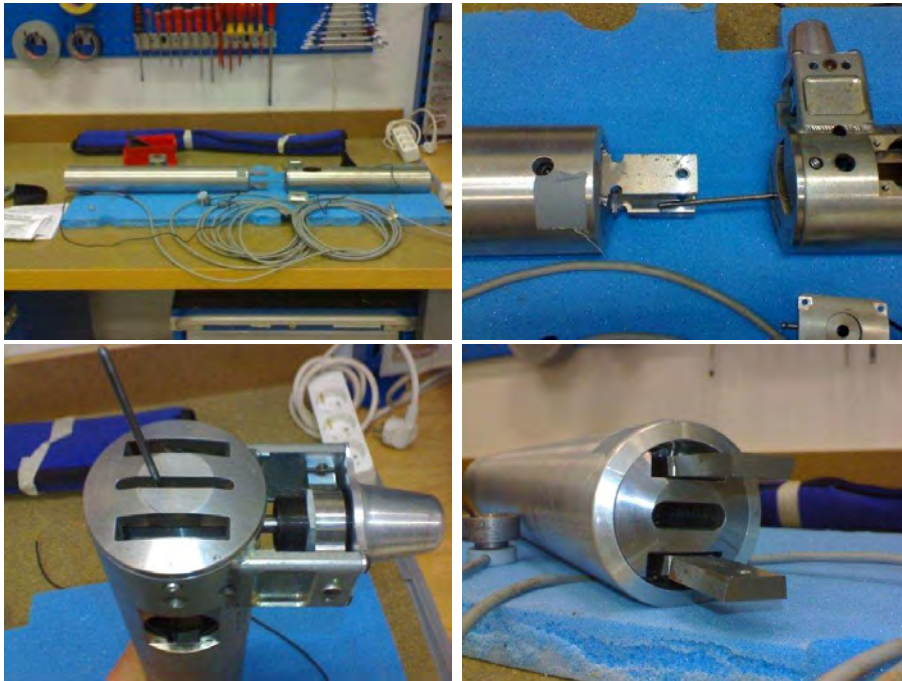
Rys. 6.23. Szczegóły budowy fantomu kończyny dolnej. Zdjęcia z pracy [99], dzięki uprzejmości Iztoka Cigralica z TUG.
