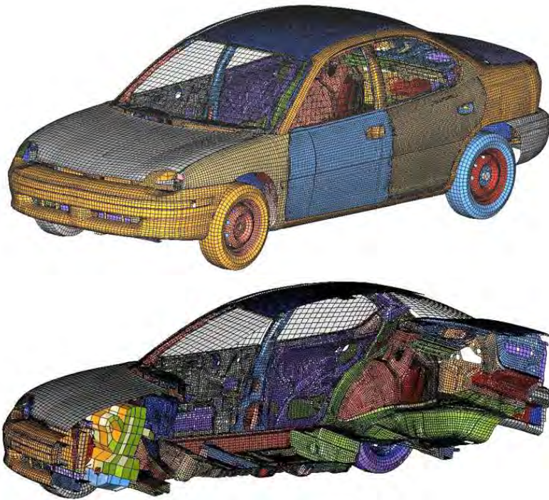
Rys. 1.1. Chrysler Neon, model MES (około 300 000 elementów skończonych). Rysunek pochodzi z raportu projektu APROSYS, zob. [198].
