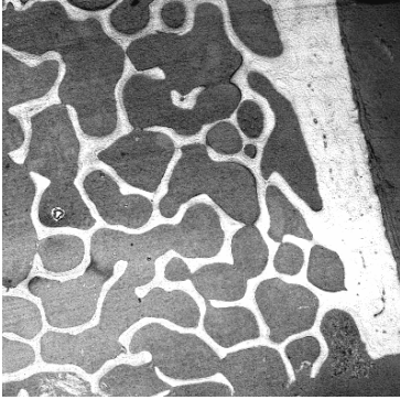
Rys. 2.3.5 Obraz struktury beleczkowej wraz z częścią kości zbitej otrzymany przy częstotliwości 35MHz. Obszar obrazowania 6,4mm x 6,4mm.
