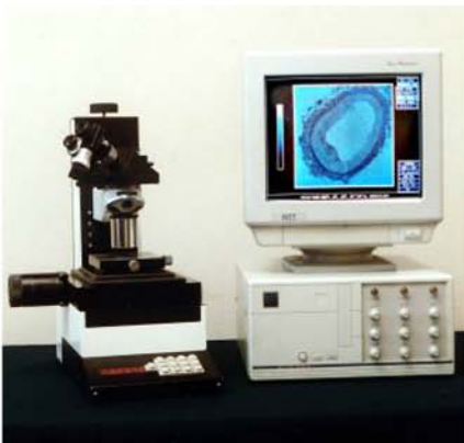
Rys.2.2.1 Skanujący Mikroskop Akustyczny – Układ zbudowany i wykorzystywany przez autora do pomiarów własności beleczek kości gąbczastej
