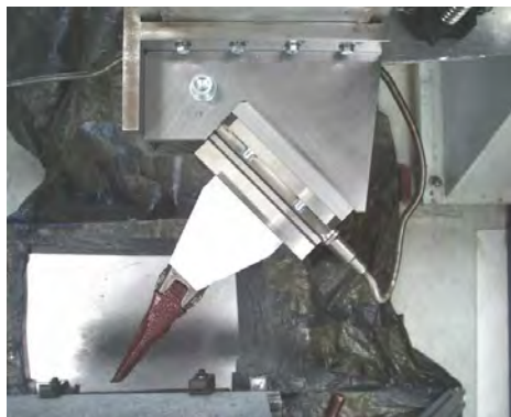
Rys. 17.3. Stanowisko do laboratoryjnych badań odporności na zużycie w ZFS (Zentrum Fertigungstechnik Stuttgart).
