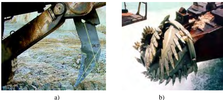
Rys. 14.1. Narzędzia do urabiania skał: a) zrywak, b) głowica urabiająca pogłębiarki.
