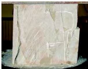
Rys. 14.6. Zniszczenie próbki skały w próbie jednoosiowego ściskania.
