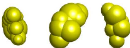
Rys. 1.3. Tworzenie nieregularnych ziaren z cząstek sferycznych [185].
