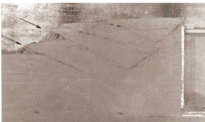
Rys. 2.9 Mechanizmy deformacji dla naporu narzędzi przy poziomym brzegu swobodnym. a) napór płaskiej ściany, b) napór ścian o szerokości 65 mm, c) napór modelowej łyżki w kształcie litery „L”.
