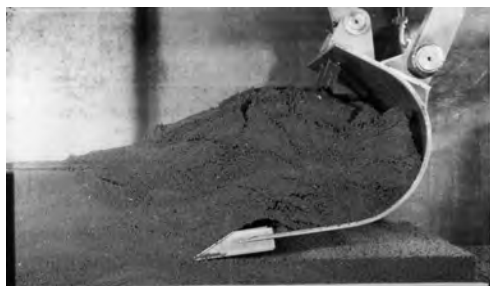
Rys. 2.44 Kolejne etapy procesu urabiania dla łyżki z nakładaną listwą, ośrodek o spójności c=15 kPa.
