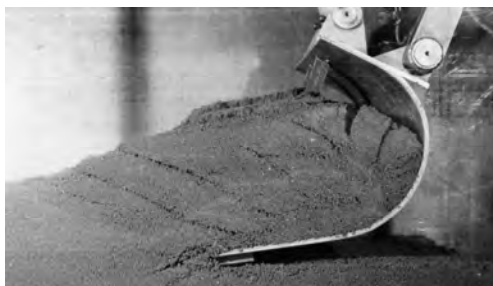
Rys. 2.43. Kolejne etapy procesu urabiania dla łyżki z 5-ciooma zębami przestrzennymi, ośrodek o spójności c=15 kPa.
