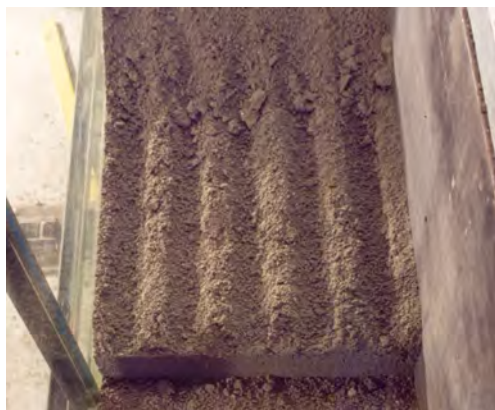
Rys. 2.37. Widok próbki po wykonaniu testu skrawania łyżką z 5-ciooma zębami.
