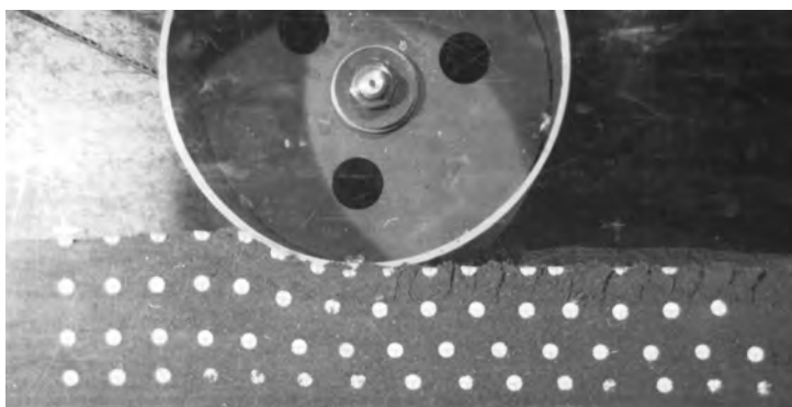
Rys. 2.56. Struktura warstwy ośrodka w trakcie procesu zagęszczania walcem wleczonym
