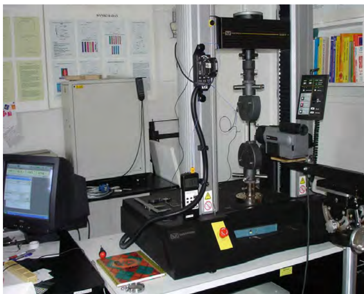
Rys. 2.7. Fotografia stanowiska do termomechanicznych badań materiałów z pamięcią kształtu w procesie rozciągania.
