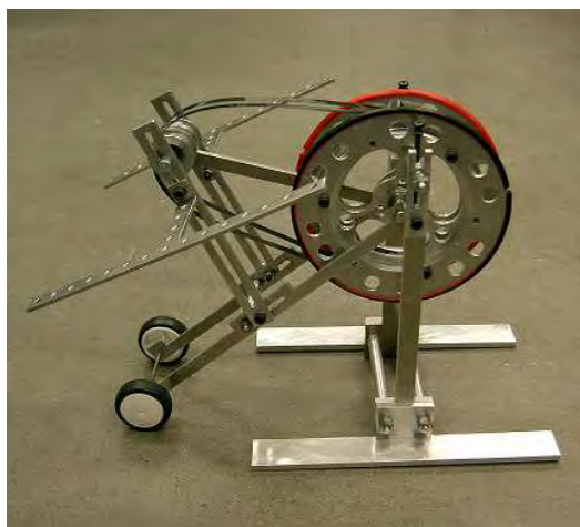
Rys. 10.9. Projekt silnika ciała stałego na bazie TiNi SMA, zaprojektowanego przez studentów w ramach prac dyplomowych; AIT, Toyota-city (fotografia własna).
