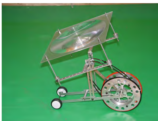
Rys. 10.5. „Solar vehicle”- ekologiczny pojazd, oparty na własnościach stopu TiNi SMA, sterowanych energią słoneczną, zaprojektowany przez studentów w ramach prac dyplomowych; AIT, Toyota-city (fotografia własna).
