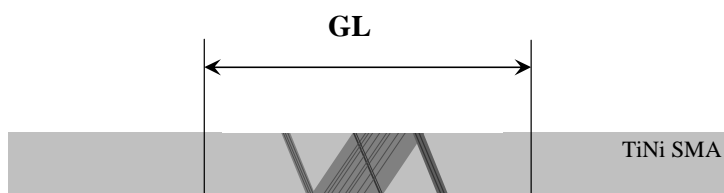
Rys. 3.27. Schematyczny szkic pasm zlokalizowanej przemiany fazowej obserwowany podczas rozciągania próbki ze stopu TiNi z pamięcią kształtu.
