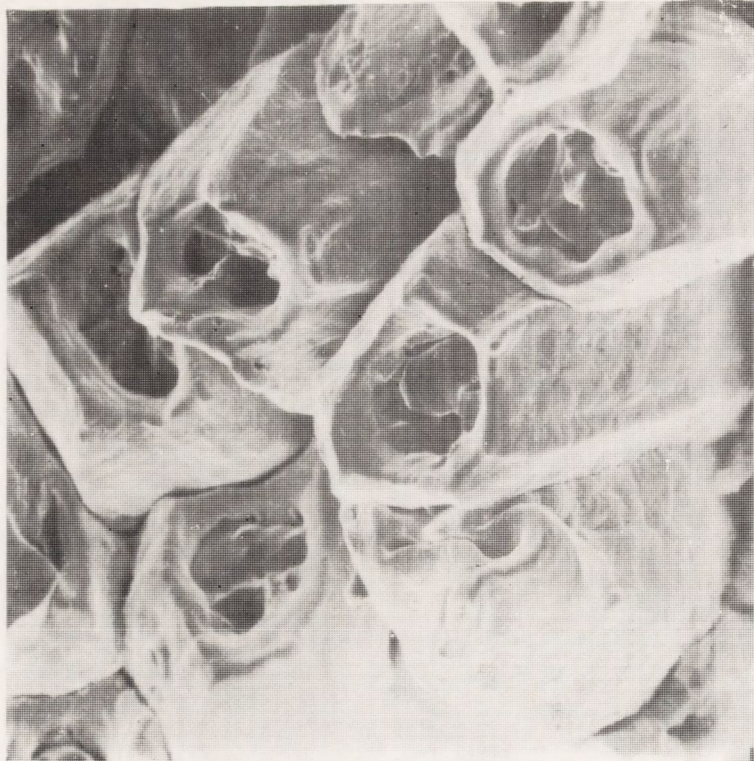
Rys. 10. Przekłony drutów rdzeniowych częściowo zasklepionych. Widoczne włókno niklowe i odkształcona otulina drutu rdzeniowego w postaci nieregularnych sześciokątów
