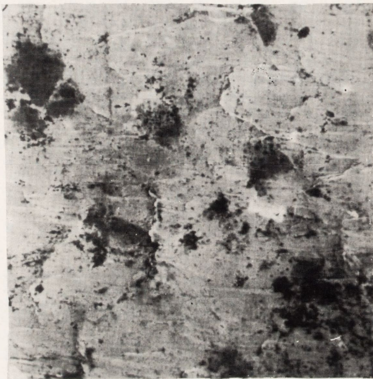
Rys. 21. Powierzchnia nakładki po przeróbce plastycznej
