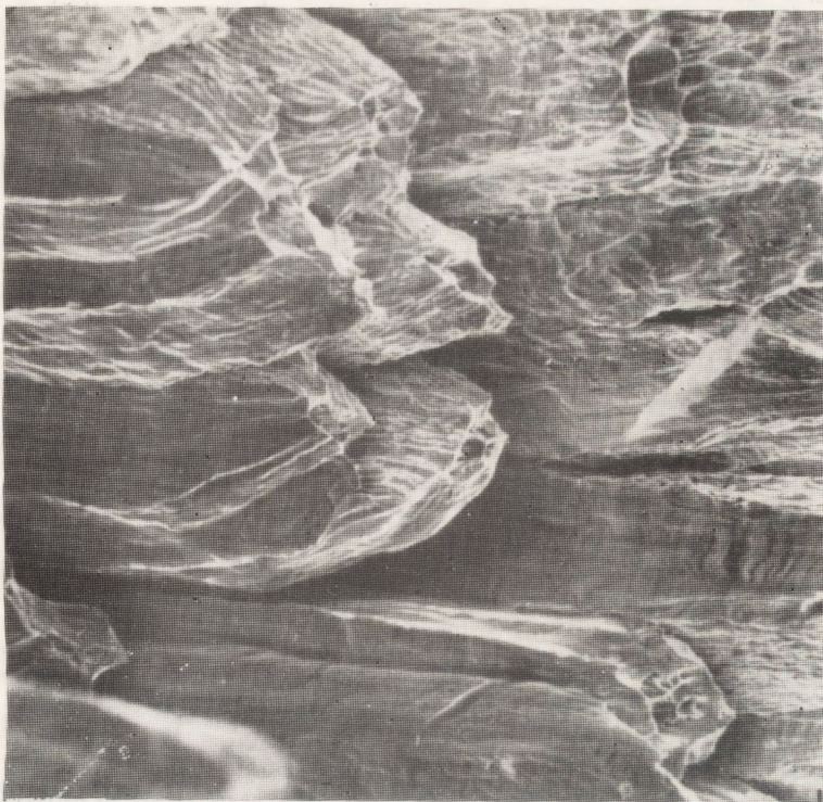
Rys. 8. Fragment przekroju próbki zerwanej. Widoczne zasklepienia włókien niklowych
