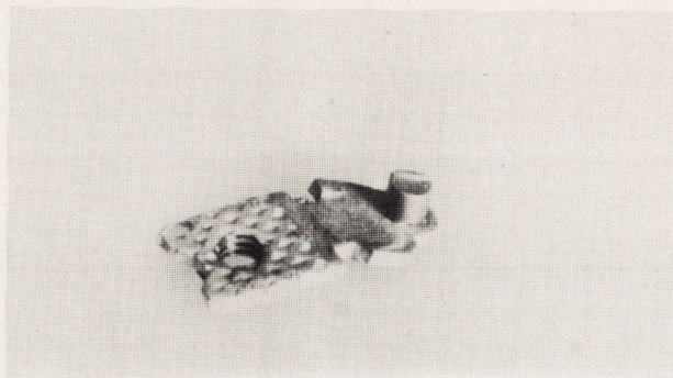
Rys. 13. Drut kompozytowy zgrzany do podłoża
