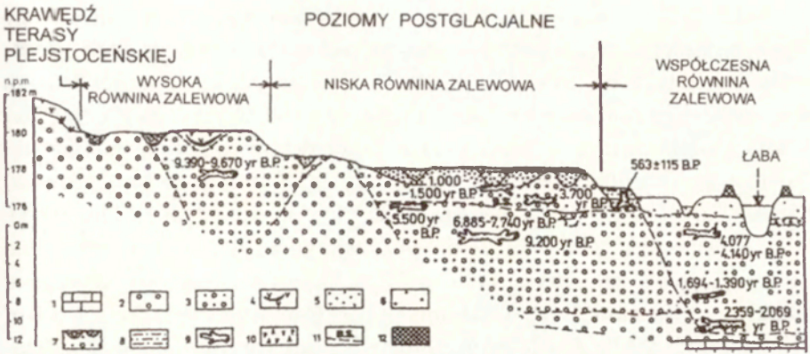
Ryc. 11. Schematyczny przekrój geologiczny przez dolinę środkowej Łaby (Ružičková, Zeman 1994b). 1 – gómkredowe margle, 2 – górnoplejstocenijskie fluwialne żwiry z piaskami, 3 – piaski fluwialne z domieszką żwirów, 4 – piaski eoliczne lokalnie z wkładką wulkanicznych (?) pyłów (zaznaczonych jako czarne soczewki), 5 – górnoholocenijskie gliny i gliny piaszczyste, 6 – gliny fluwialne (mady), 7 – osady wypełniające starorzecza (gliny i piaski), 8 – średnioziarniste piaski fluwialne z domieszką żwirów, 9 – pnie czarnych dębów, 10 – fragmenty cegieł, 11 – przypuszczalne granice geologiczne, BS – poziomy kopalny, 12 – wały przeciwpowodziowe
