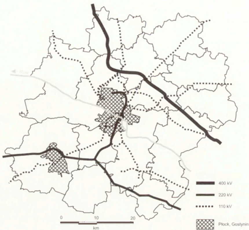
Ryc. 24. Linie najwyższego (NN) i wysokiego (WN) napięcia. Źródło: dane gminne oraz Z.E. Płock S.A. Lines of the highest (NN) and high (WN) voltage. Source: communal data and Electricity Board Płock
