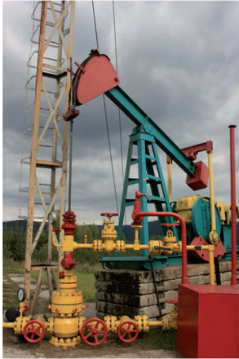
Ryc. 29.4. Pompa (tzw. kiwon lub kiwak) służąca do pompowania ropy naftowej ze złoża o niskim ciśnieniu – Dwernik (fot. J. Wolski, 2010)
