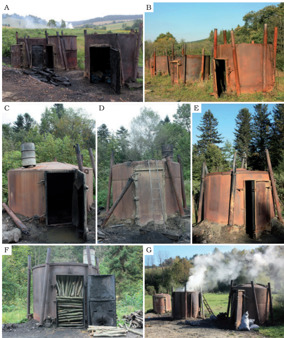
Ryc. 39.8. Działające, nieczynne lub obecnie już nieistniejące retorty: A – Żernica Niżna, B – okolice Rabego k. Baligrodu, C, D – Caryńskie, E – okolice Łokcia, F – Łopienka, G – Żerdenka (fot. J. Wolski, 2006, 2010)
