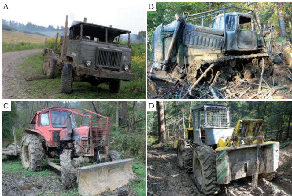
Ryc. 38.6. Sprzęt do zrywki i wywozu drewna: A – Star 660, B – DT75, C – MTZ-82, D – LKT-81 (fot. J. Wolski, 2010)
