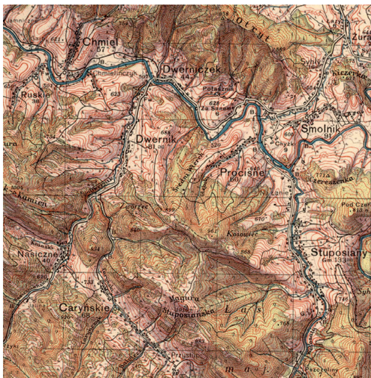
Ryc. 5.23. Mapa taktyczna WIG w skali 1:100 000 z lat 1933-1939 – typ turystyczny sześciobarwny (fragment arkusza P52 S35 Dźwiniacz Górny z 1937 r.)
