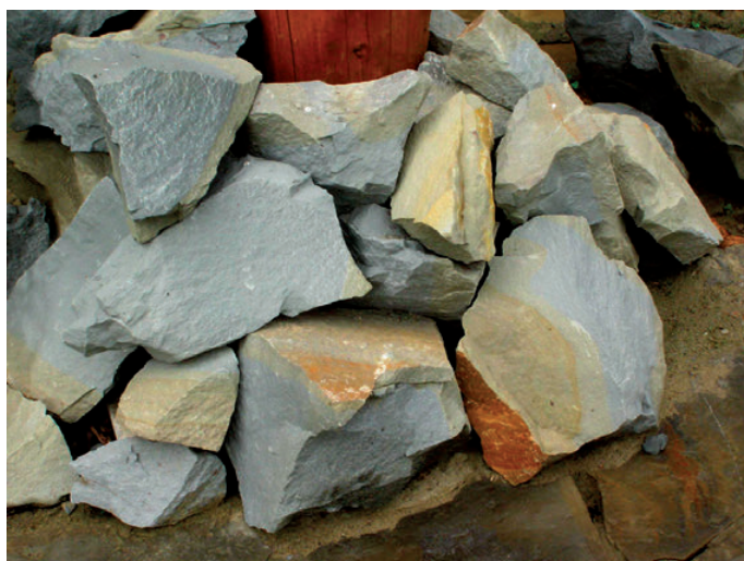
Ryc. 6.5. Świeżo wydobyte i pokruszone bloki piaskowca otryckiego w różnym stopniu zwietrzałe (stalowo-szara barwa świeżego przełamu rudzieje w wyniku ekspozycji na warunki zewnętrzne) (fot. G. Haczewski)
