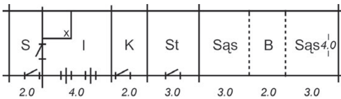
Ryc. 20.60. Zagroda złożona z domu centralnego z sienią w szczycie, stajni w środku i stodoły, 1748 r. – Bahnowate, rej. turczański
