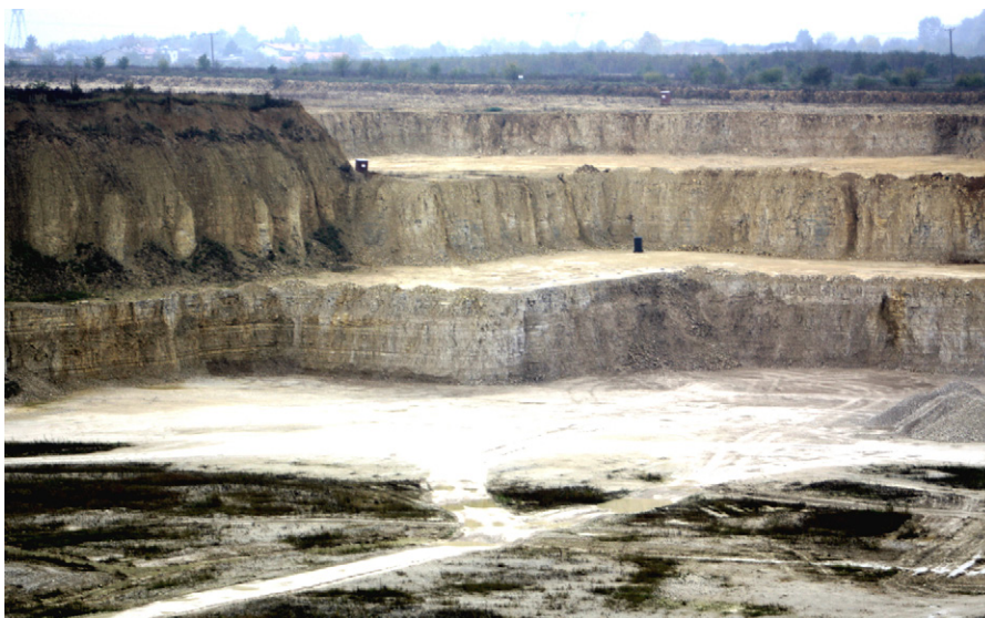
Fot. 3. Głęboka kopalnia wapienia w Rudnikach koło Częstochowy, stale odwadniana (eksploatacja 35 m poniżej poziomu wód gruntowych)
