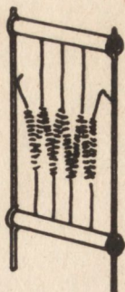
Rys. 8. Przykładowe kształty skrętki żarnika żarówki halogenowej
